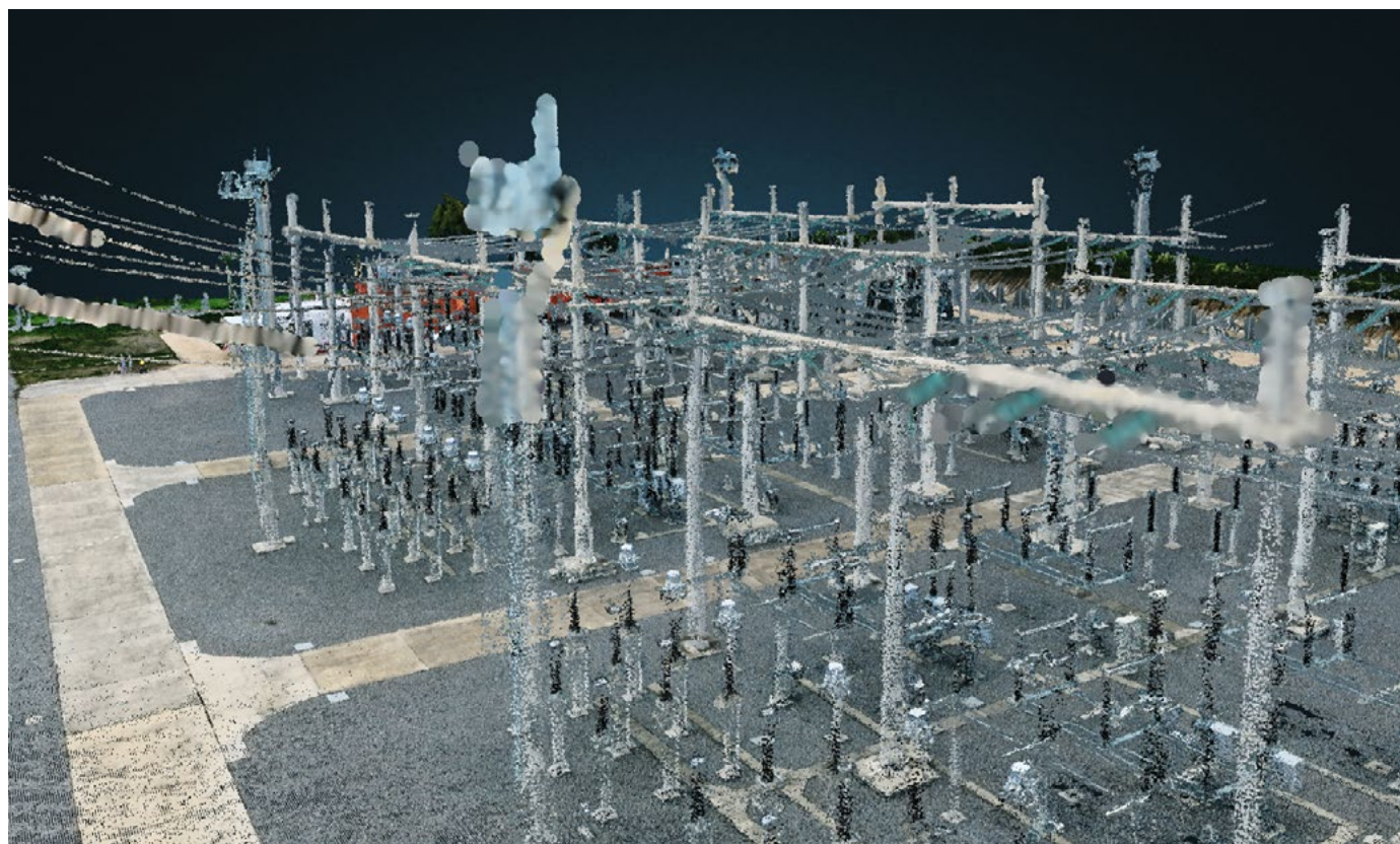
Ilustración 1: Nube de Puntos escaneada con Dron.
